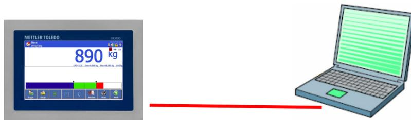
Figure B-1: Conexión del IND900 a un PC con un cable crossover
