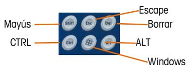
Figura 1-10: IND970-15 Teclas de función Windows, detalle
