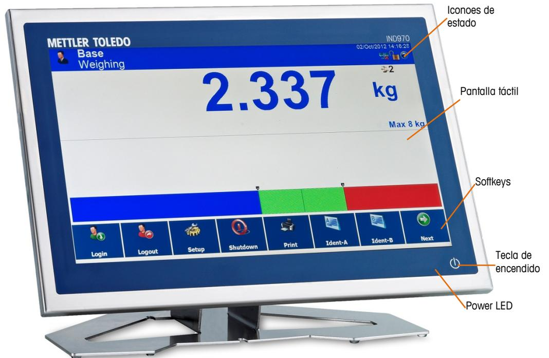
**Figura 2-5: Componentes de manejo y posiciones de las teclas en IND970-19**
