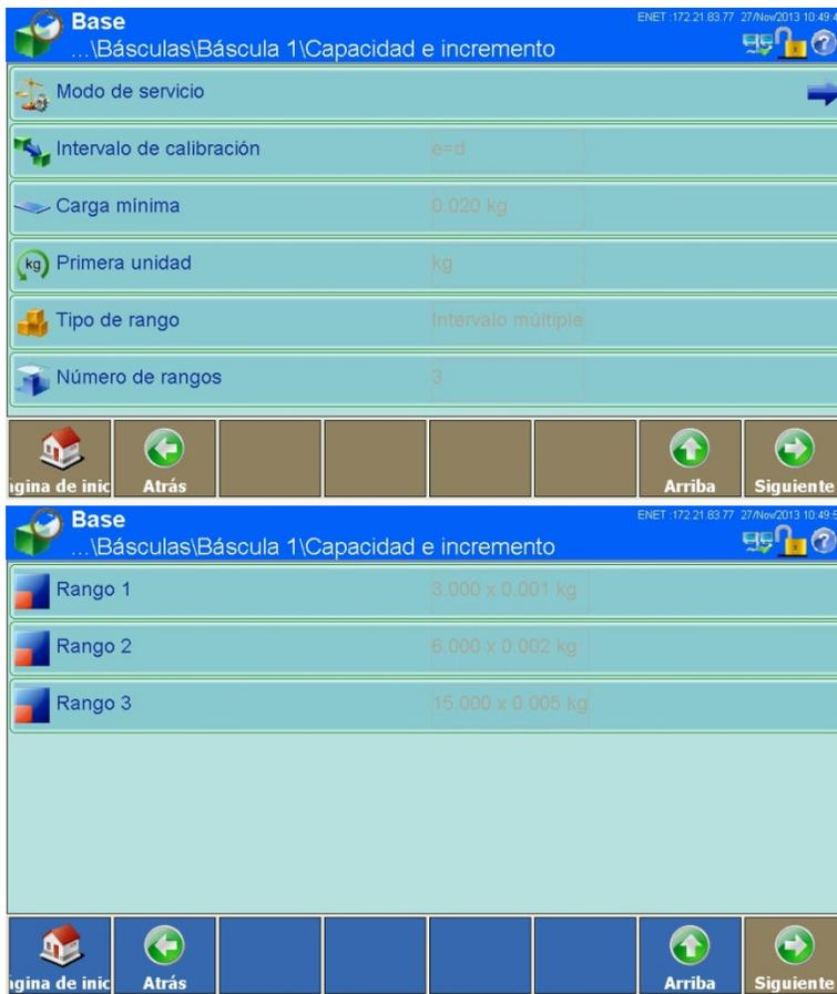
**Figura 3-11: Menú Capacidad e incremento en básculas analógicas sin ASM**
