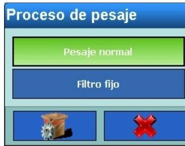
**Figura 3-70: Selección de Adaptador del proceso de pesaje en básculas analógicas**
